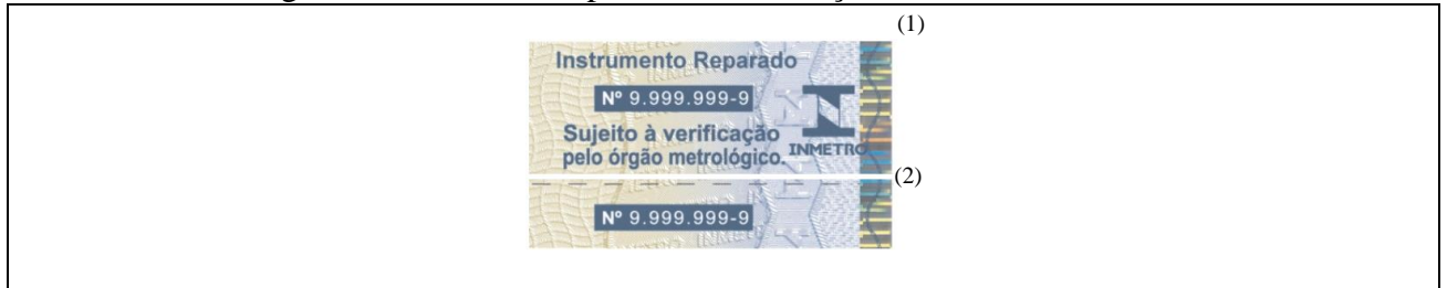
Figura 1 – Marca de Reparo (1) e Numeração de Controle (2)
